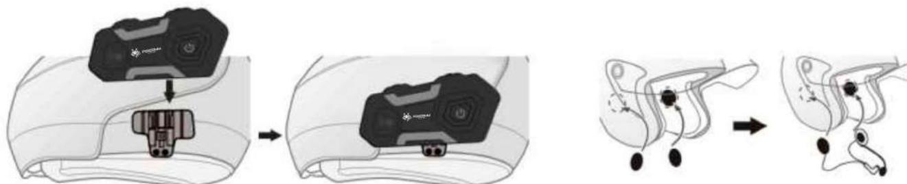
3) Deslice el receptor hacia abajo en las ranuras de la montura de la abrazadera del auricular, asegúrese de que esté bloqueado de forma segura.
