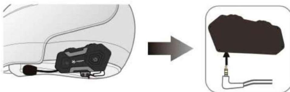
6) Inserte el enchufe de los auriculares en la toma de auriculares correspondiente en el receptor para finalizar la instalación.
