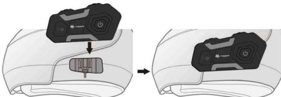
③ Deslice el receptor hacia abajo en las ranuras de la montura de la abrazadera, asegúrese de que esté bien asegurado.
